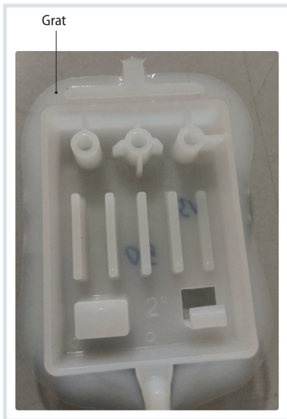
Bild 3. 50stes Spritzgussteil aus dem Formein-satz Digital ABS Plus Ivory mit Grat an der Bauteilaußengeometrie. © Hochschule Coburg
